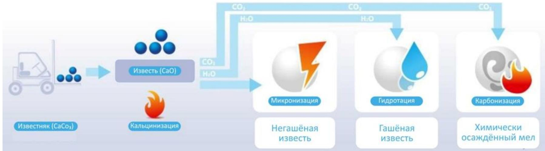
Рисунок 1. Этапы производства химически осажденного мела
