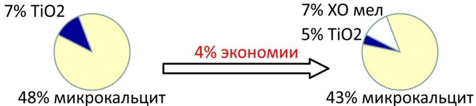
Рисунок 5. Схема замещения TiO<sub>2</sub> хо мелом
